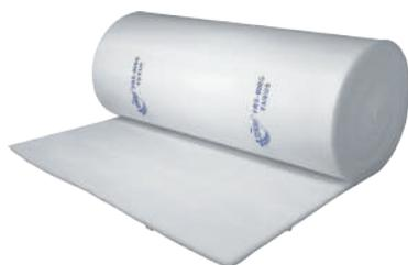
Потолочные фильтры изготавливаются из обработанного специальным составом синтетического полиэфирного волокна, обладающего повышенной адгезией, а также исключающего миграцию пыли в толще материала и отрыв частиц от поверхности фильтра. Фильтрующий мат со стороны выхода воздуха усилен удерживающей сеткой, которая повышает прочность материала.
