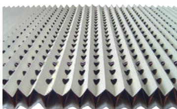
В краскоулавливающих фильтрах из гофрированного картона используется принцип инерционной сепарации. Конструкция фильтра такова, что при попадании в фильтр насыщенного воздуха, воздух вынужден несколько раз менять свое направление. Это приводит к тому, что те частицы, которые тяжелее воздуха оседают на стенках, а воздух продолжает свое движение, не встречая особых препятствий
