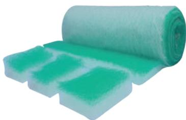
Напольные фильтры изготавливаются из стекловолокон различного поперечного сечения толщиной от 50 мм до 100 мм. Структура материала такова, что по направлению движения воздуха диаметр волокон уменьшается, а плотность упаковки волокон увеличивается. Такое строение исключает преждевременное загрязнение поверхности фильтрующего материала со стороны входа воздуха и, как следствие, увеличивает пылеемкость, эффективность и срок использования самого фильтра.
